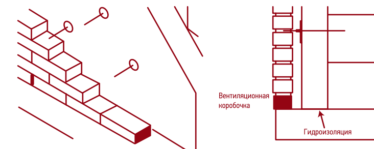
Вентиляционные коробочки каждые 3 кирпича
